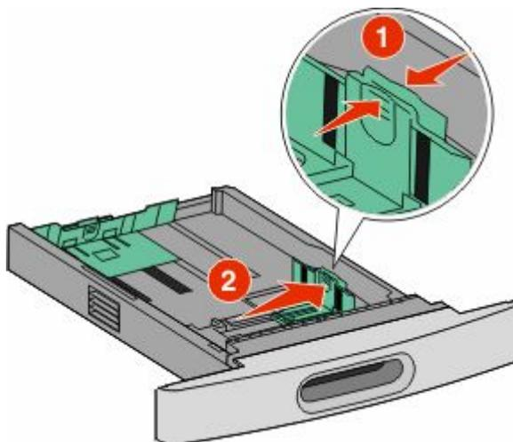
3 Разблокируйте направляющую длины, сожмите фиксатор направляющей длины бумаги, как показано на рисунке, и передвиньте направляющую длины
